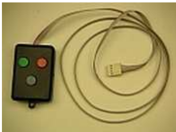
Programmiergerät Es verfügt über ein etwas längeres Anschlusskabel, um beweglich bleiben zu können.
